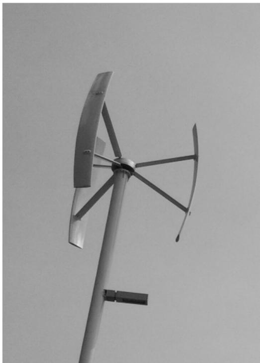
**Figure:** Turbina eolica ad asse verticale.
